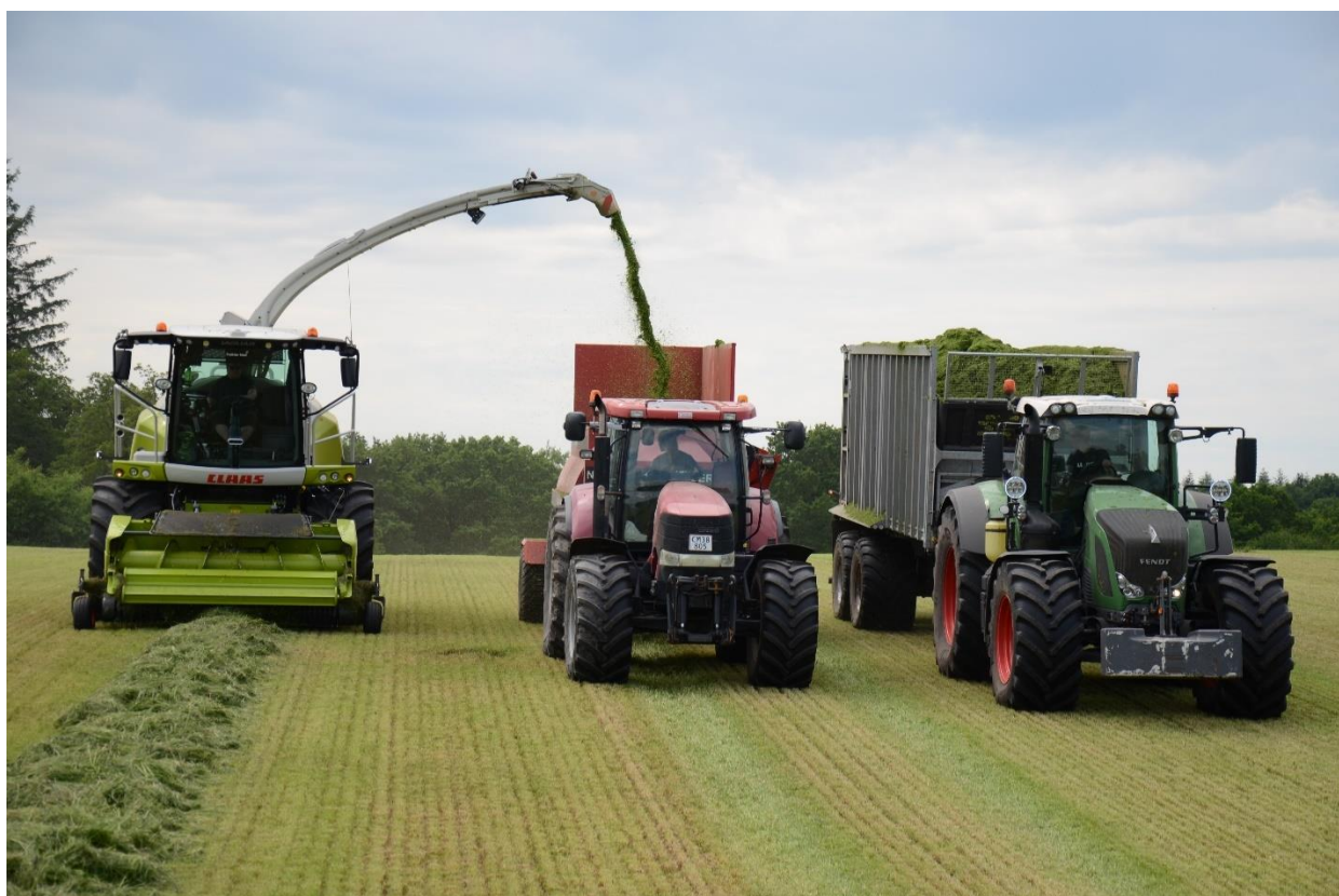
Foto 1. Samtidig opsamling af NIR-spektre og grønmasse. Referenceprøven til de opsamlede NIR-spektre forblendes i Nolan blanderen inden videre prøveneddeling.
